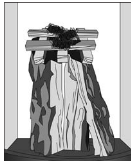
FIG. 4.5 Chambre de combustion haute
